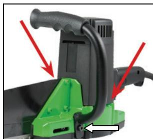
Der Zusatzhandgriff kann je nach Arbeitsweise rechts oder links an der Maschine montiert werden.
